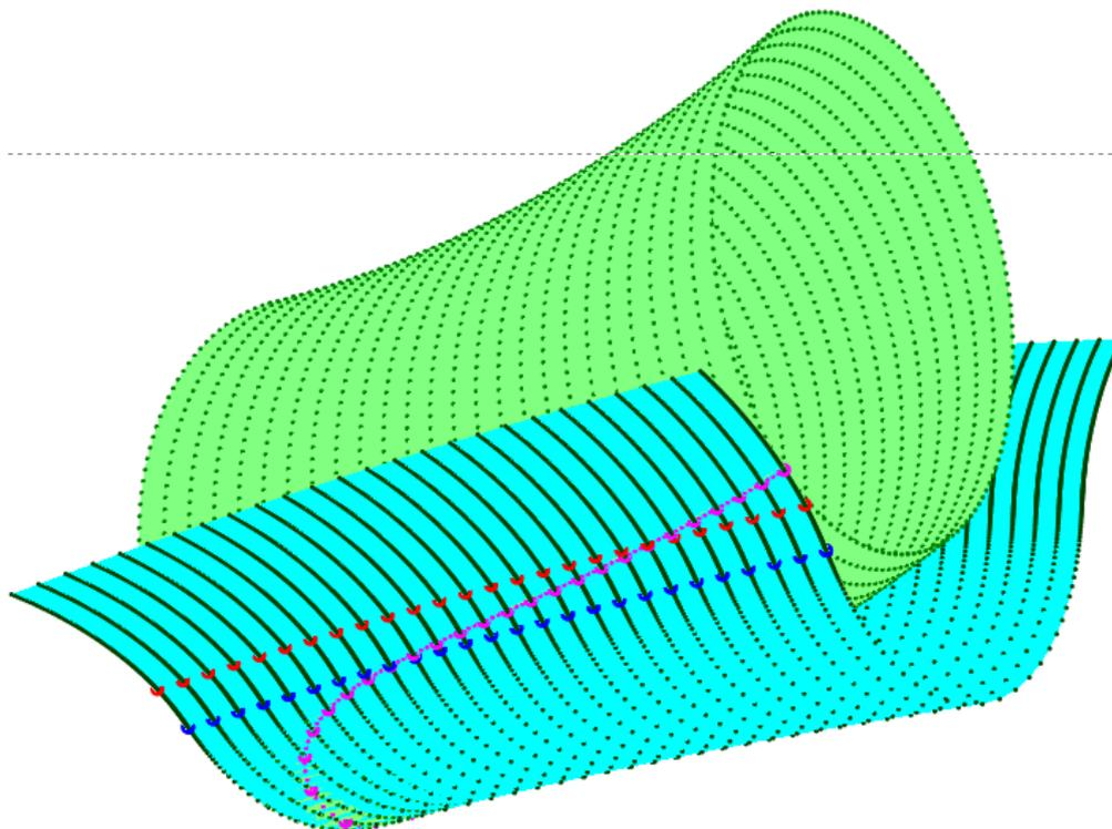
Определение кривизны поверхности зуба шестерни (зелёный цвет) и колеса (синий цвет) вдоль линии контакта.
