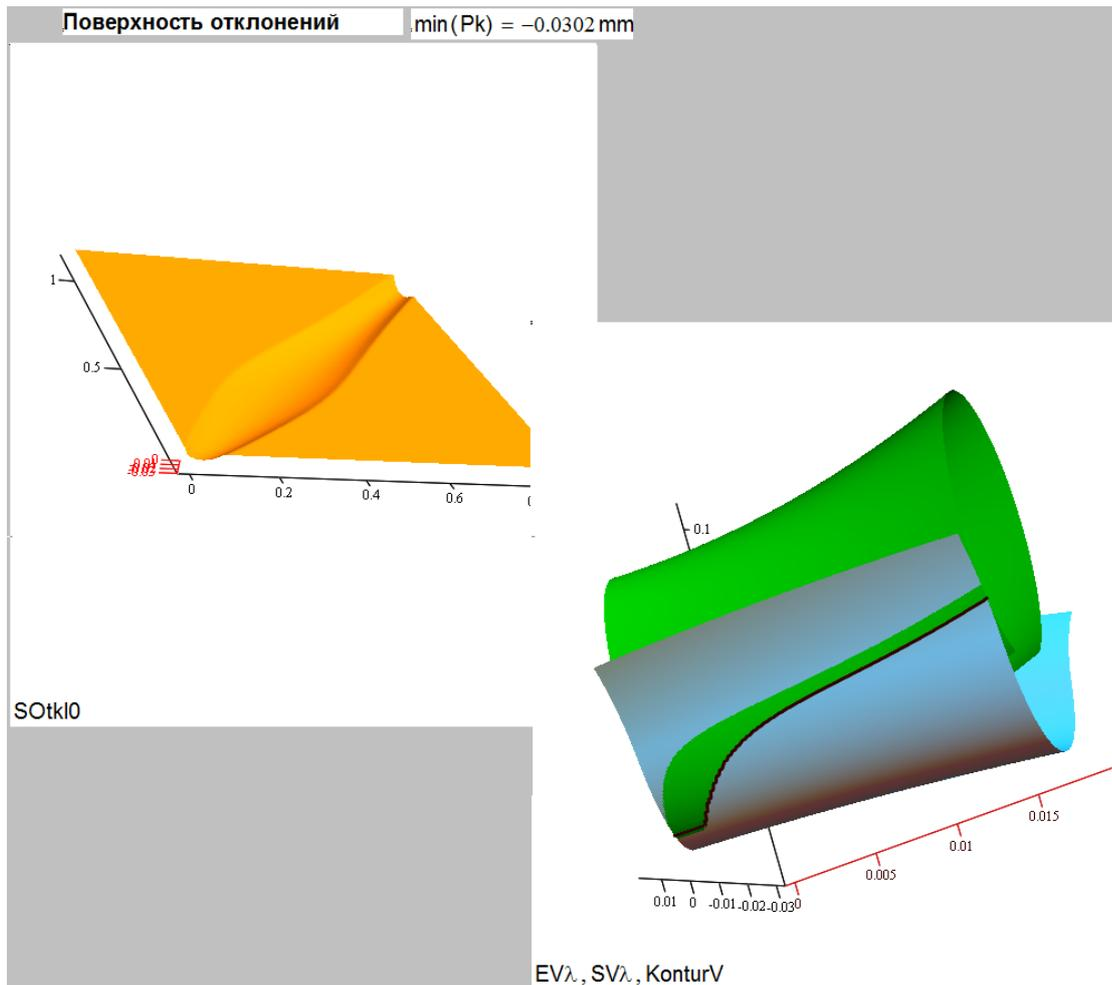
Площадь куска поверхности **вых.дет**, ограниченной контуром пятна контакта при проникновении на 30 мкм на одном зубе без модификаций:
